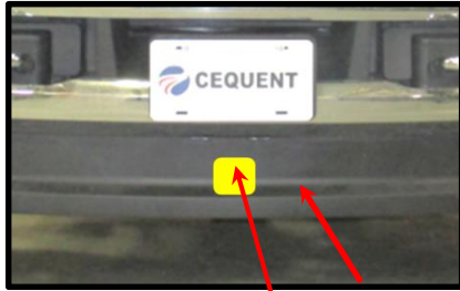
Figura 2 Retenedor de aire a recortar Parte inferior del retenedor de aire.
