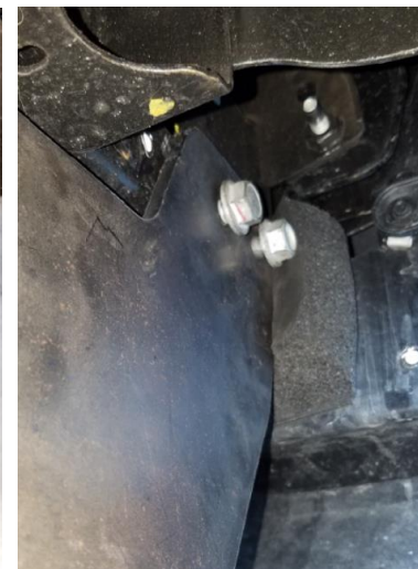
Pernos de brida del gancho de remolque del lado del pasajero
